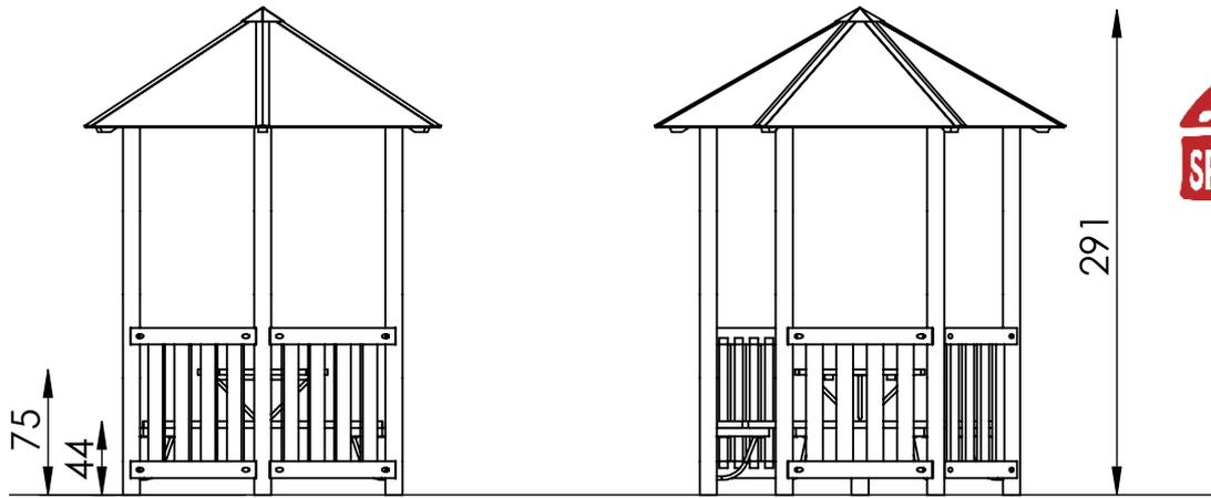
Das Gerät wird als eine Sitzgelegenheit gewertet. Deshalb ist der Einbau auch ohne falldämpfenden Untergrund gestattet !
