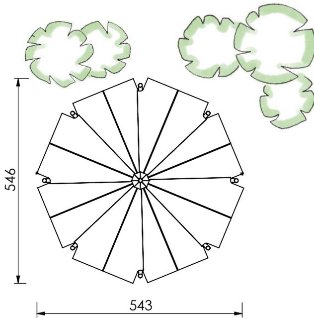
Das Gerät wird als reine Sitzgelegenheit gewertet. Deshalb ist hier der Einbau auch ohne falldämpfenden Untergund gestattet !
