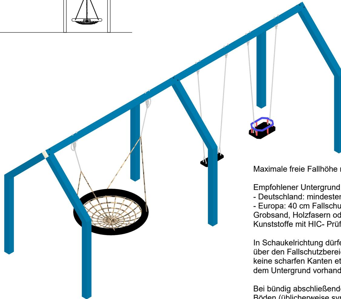
Maximale freie Fallhöhe nach EN 1176: 150 cm
