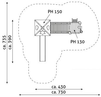
Maximale freie Fallhöhe: 180 cm Empfohlener Untergrund: 40 cm Fallschutzkies 2/8 mm Grobsand, Holzfasern oder Kunststoffe mit HIC-Prüfung.
