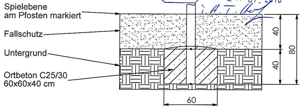
**Fundamentdetail Rutschstangen/ Bogenleiter c)**
