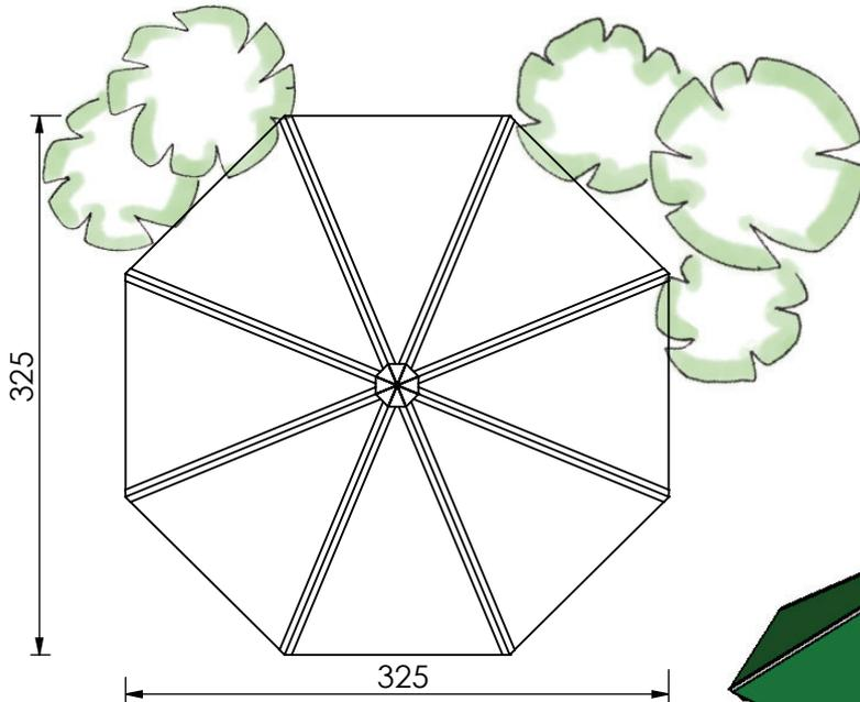
Das Gerät wird als reine Sitzgelegenheit gewertet. Deshalb ist hier der Einbau auch ohne falldämpfenden Untergrund gestattet!
