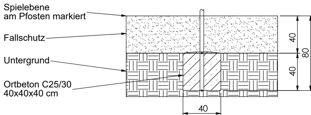
**Fundamentdetail Seiltunnelanker c1)**
